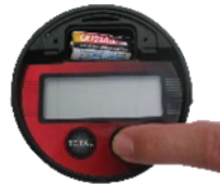
Schéma 4: Insérer la nouvelle pile et appuyer sur RESET pour vérifier les fonctions
