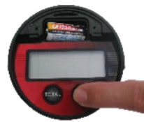
Abbildung 4: Bild 3: Neue Batterie einsetzen, danach die RESET Taste drücken, um die Funktion des Zählwerks zu prüfen
