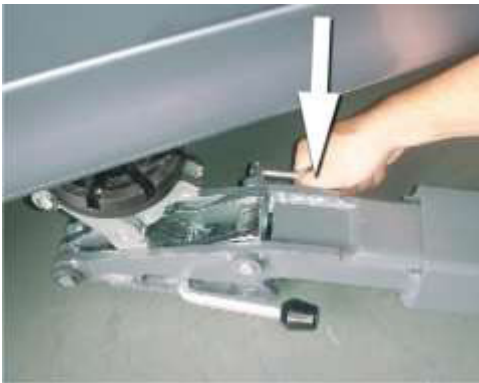
Kuva 3: Vapauttaaksesi nostotalan paina lukitusvipua alaspäin.
