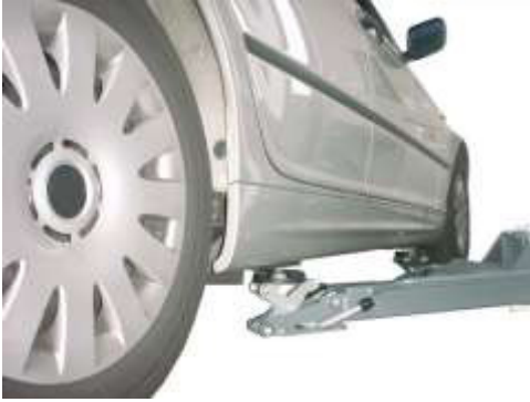
Kuva 1: Aseta nostotallat ajoneuvon valmistajan ilmoittamien nostokohtien kohdalle.
