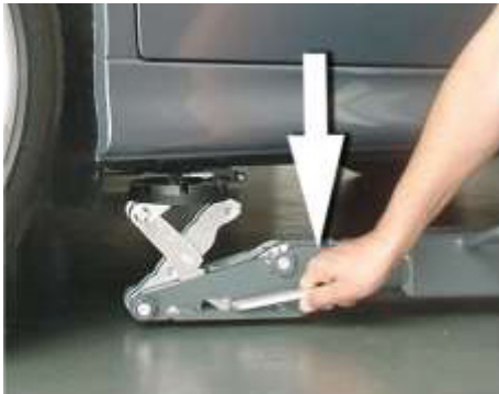
Kuva 2: Säädä korkeutta tarvittaessa painamalla vipua alaspäin.
