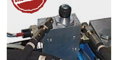
La sincronizzazione idraulica dei movimenti delle pedane è indipendente dalla ripartizione del carico; ed è garantita da un dispositivo di sincronizzazione idraulica brevettato.
