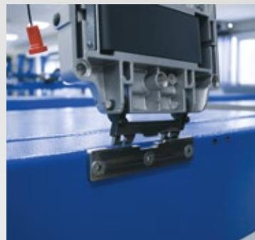
Pedana perforata per il montaggio delle staffe a supporto delle teste di misura dell'assetto ruote 3D Ravaglioli. (Solo per modelli .2, .3, .5).
