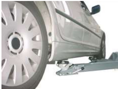
Kuva 1: Asenna nostotallat ajoneuvon valmistajan hyväksymien nostopisteiden alapuolelle
