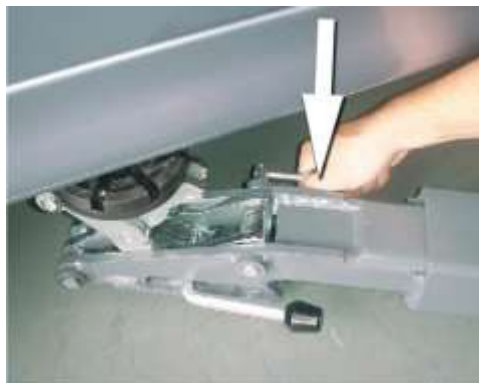
Kuva 3: Nostotallan vapauttamiseksi paina nostovarren takavipua
