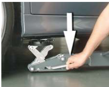
Kuva 2: Voit nostaa nostotallan tarvittaessa nostopisteeseen painamalla nostovarren vipua.
