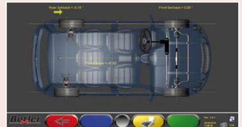
La **diagnosi rapida** del disassamento del telaio permette di evidenziare eventuali problemi di carrozzeria o di spostamento del retrotreno.
