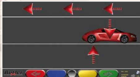
È possibile la misurazione del fuori centro spingendo il veicolo di 30° (compensazione rapida e in poco spazio)\* senza necessità di sollevare il veicolo.
