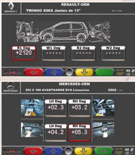
La banca dati modifica automaticamente le specifiche di assetto in funzione dell'altezza del telaio.
