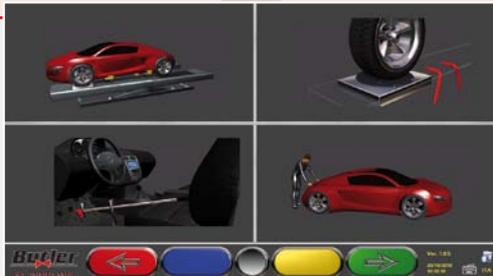
Il **programma movie**, tramite grafica animata 3D, visualizza la sequenza delle operazioni da effettuare per eseguire una corretta registrazione del veicolo.
