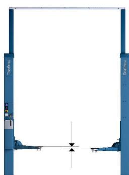
Nostovarsien asentamisen ja nostimen tasauksen jälkeen nostovarsien korkeusero voi olla 20 mm valmistustoleransseista johtuen.
