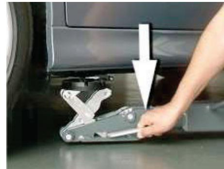
*Kuva 2: Aseta Mini Max nostotalla tarvittaessa paikalleen painamalla vipua nostotallan alapuolella.*
