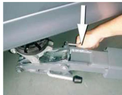
*Kuva 3: Mini Max nostotallan vapauttamiseksi on työnnettävä takavipua..*
