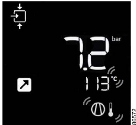
Päänäyttö ja lämpötilan lähtövaroitus
