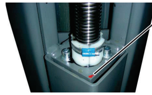
Kuva 18: Nostomutterin tappissa on tiivistysvahaa
